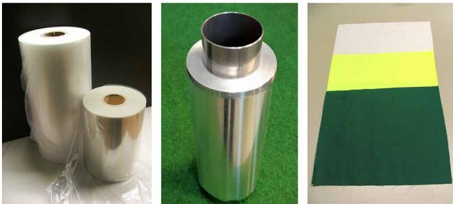
Praxisrelevante Versuchsreihen zur Oberflächenbehandlung von Bahn- und Rollenware wie Polymer- oder Metallfolien, textiler Materialien oder Papier mittels flammenpyrolytischer  $\text{SiO}_x$ -Abscheidung an einer R2R-Anlage
