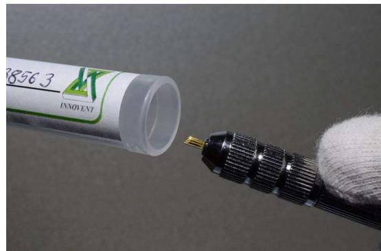
Probenentnahme mit dem Technischen Wattestäbchen
