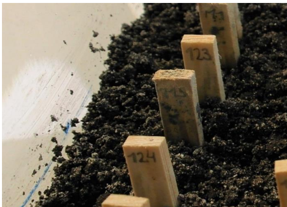
Moderfäuletest nach DIN V ENV 807, 32 Wochen Versuchszeitraum, Bestimmung der Massedifferenz
