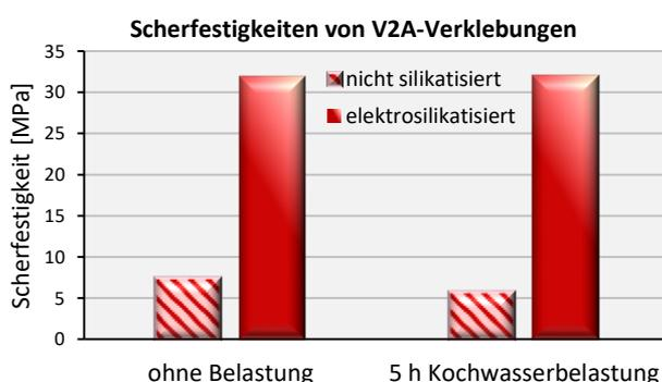
Beispiel für die Haftungsverbesserung eines V2A-Klebeverbundes durch Elektrosilikatisierung & Haftsilan - unbelastet & nach Kochwasserbelastung; Klebstoff: Epoxid-Amin; Haftsilan: Formulierung auf Basis Glycidoxypropyltrimethoxysilan
