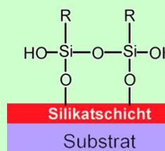
Kovalente Anbindung eines funktionellen Silans (z.B. Haftvermittler) an eine silikatisierte Oberfläche
