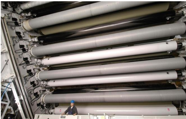
Kompositwalzen der Trockenpartie einer Papiermaschine (Foto: xperion)
